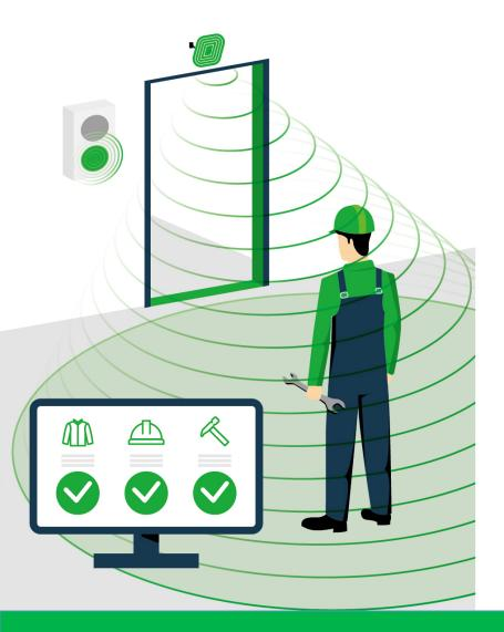
Система бесконтактно идентифицирует сотрудника по коду метки его персонального предмета, фиксирует факт присутствия и проверяет комплектность СИЗ.
