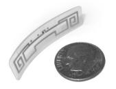
UHF RFID метки — это небольшие устройства, которые содержат микросхему и антенну для бесконтактной идентификации объектов, к которым они прикреплены.
